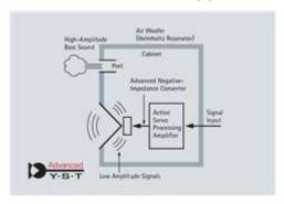
Den avancerede YST II-teknologi (Yamaha Active Servo Technology II) kombinerer principper og negativ impedans og konstant strømstyrke og opnår en endnu bedre beherskelse af højttalerenheden end den tidligere version. Ved at bruge et Advanced Negative Impedance Converter (ANIC)-kredsløb bliver den reelle højttalerimpedans dynamisk optimeret til at bibeholde en eksemplatisk linearitet. Det gør responsen i bunden af frekvensområdet mere stabil og dermed lydkvaliteten højere.
